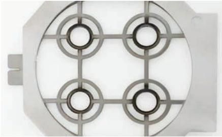
◀ 電極プレートの中心部の焦げ付き汚れの例
