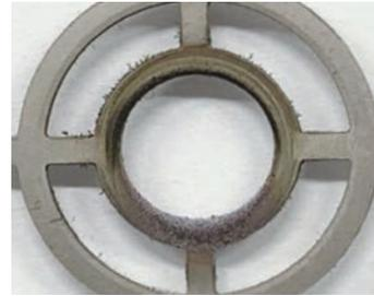
◀ 電極プレートの中心部の汚れの例
