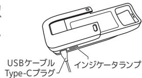
2. 別売のエアークセスニューミニ(型番:ASM-005)のUSBコネクタを取り出し、本体のUSBポートに差し込みます。接続中は本体のインジケータランプが緑色に点灯します。正しく接続されるとエアークセスニューミニのLEDが青色に点灯し、動作を始めます。
