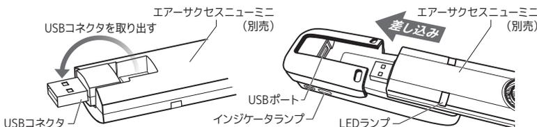
使用中にバッテリー残量が少なくなるとインジケータランプが緑色が点滅し、しばらくすると停止します。
